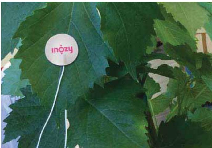
■ Le projet CAP'INOV, porté par la jeune entreprise innovante INOZY, a pour objectif de développer un système de capteurs fixes implantés sur les ceps de vignes, destinés à prendre en continu des mesures sur l'état hydrique et minéral de la plante, sans mise en œuvre de méthodes de mesures destructives.
