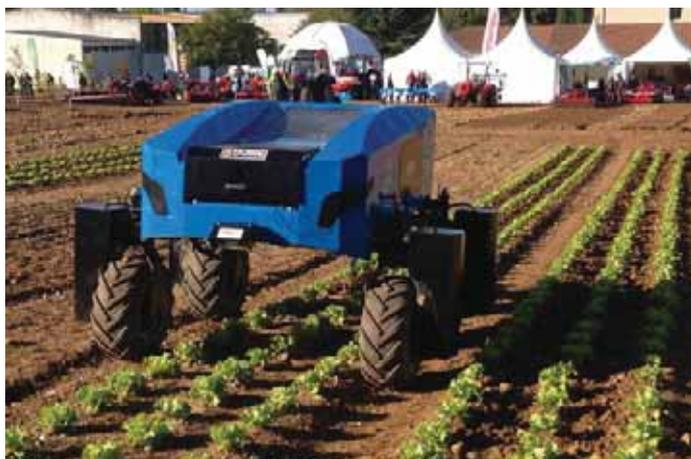
Le projet SFIM a pour objectif de développer un système de capteurs destinés à fournir des informations sur le besoin en eau des plantes. Ce dispositif sera intégré à un robot déjà existant, utilisé pour le désherbage : ANATIS.
