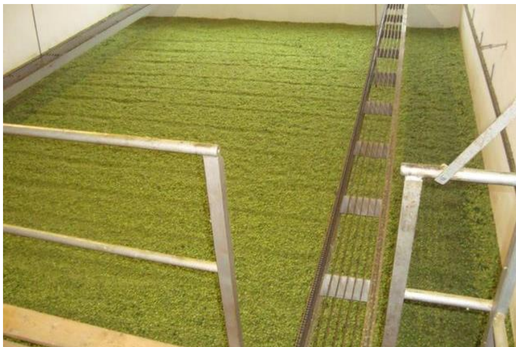
Figure 11 : Séchage du houblon sur claie 14
