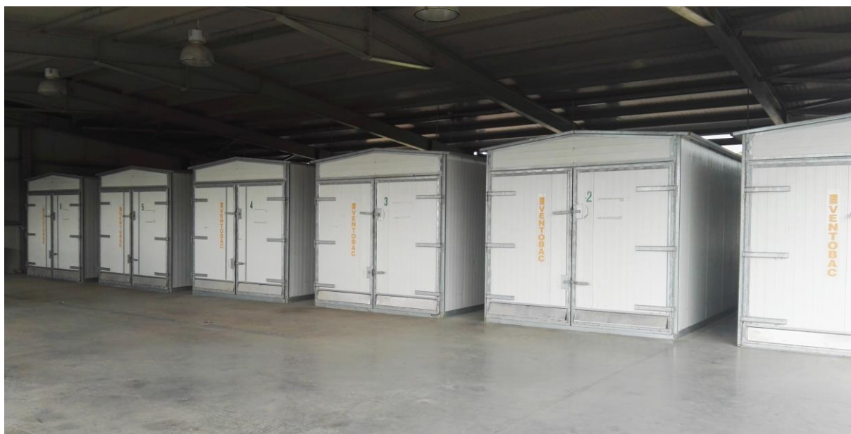
Figure 10 : Fours à tabac reconditionnés pour le séchage des aromatiques en Grèce. Volets d'ouverture métallisés visibles aux pieds des fours 12
