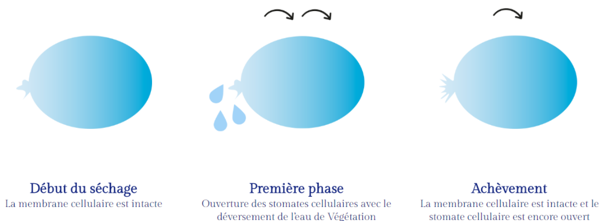
Figure 3 : processus cellulaire résultant du séchage à froid 3
