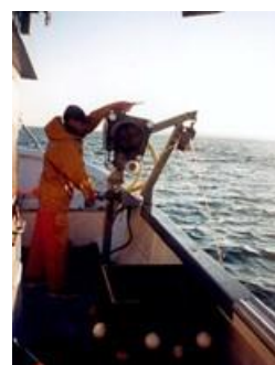
Figure 13 : Utilisation d'un vire-filet
